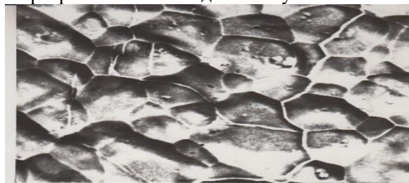
Рис.1. Микрофотография полупроводниковых силицидов на поверхности кристалла (увеличение 1400 х).
